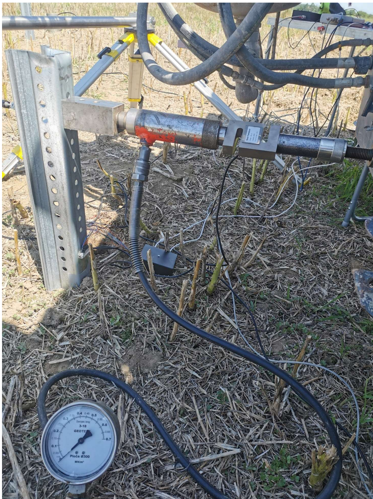
horizontalni test sa mjerenjem savijanja pomoću tenzometara
