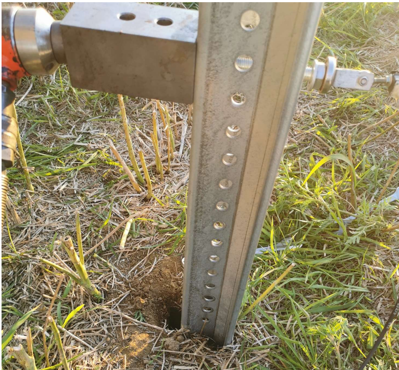
trajna deformacija nakon horizontalnog testa
